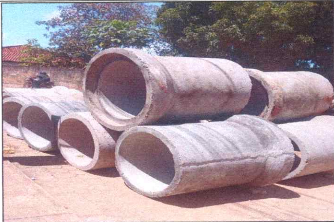
Foto 17 - AV. SÃO SEBASTIÃO - VILA NOVA - TUBO DE CONCRETO ARMADO PA2 - D= 0,80 M.
