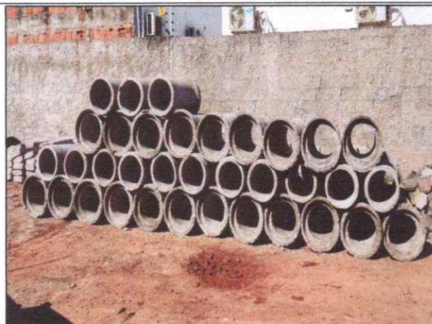
Foto 37 - SINFRA - TUBO DE CONCRETO ARMADO PA2 - D= 0,40 M.
