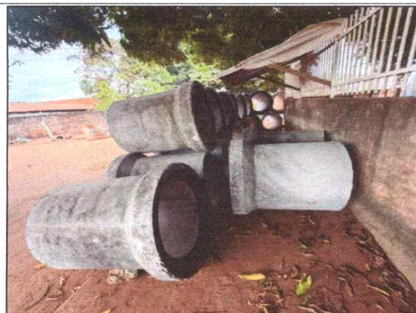
Foto 40 - AV. SÃO SEBASTIÃO - VILA NOVA - TUBO DE CONCRETO ARMADO PA2 - D= 0,80 M.
