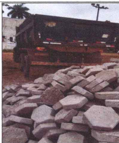
Foto 13 - SINFRA – BLOQUETE HEXAGONAL SEXTAVADO 25X25X8.
