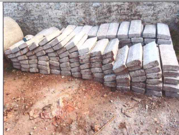
Foto 38 - SINFRA - MEIO FIO DE CONCRETO 80 CM.
