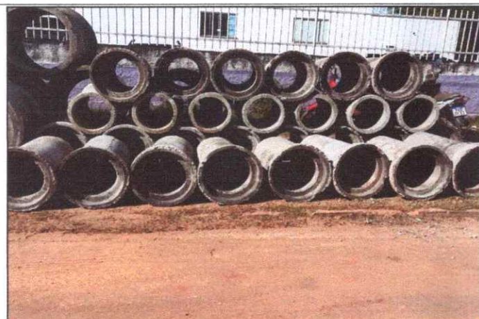
Foto 7 - AV. SÃO SEBASTIÃO - VILA NOVA - TUBO DE CONCRETO ARMADO PA2 - D= 0,40 M.
