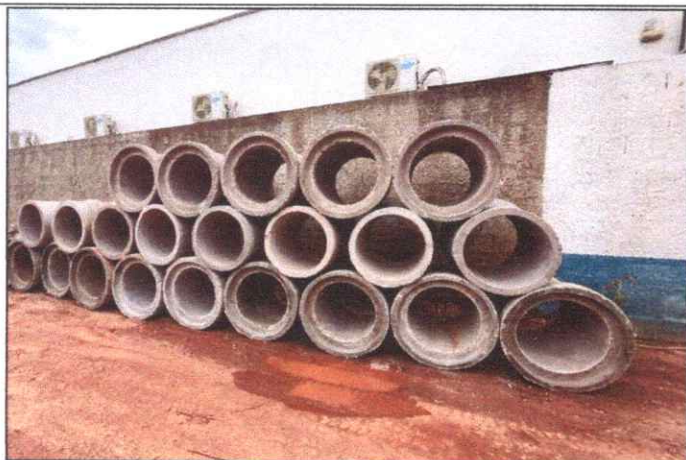
Foto 15 - SINFRA - TUBO DE CONCRETO ARMADO PA2 - D= 0,80 M.
