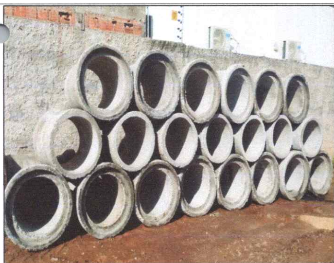
Foto 1 - TUBO DE CONCRETO ARMADO PA2 - D= 0,80 M.
