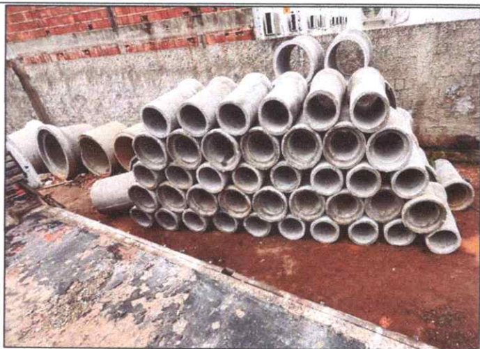
Foto 3 - SINFRA - TUBO DE CONCRETO ARMADO PA2 - D= 0,40 M.
